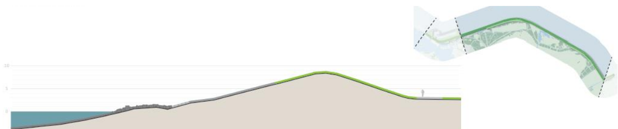
Figuur 86: Huidig profiel dijk van het deeltraject Landelijke dijk 1 en 2
