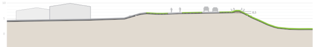
Figuur 7: Alternatief kade aan meerzijde op bestaande dijk (afgefallen)
