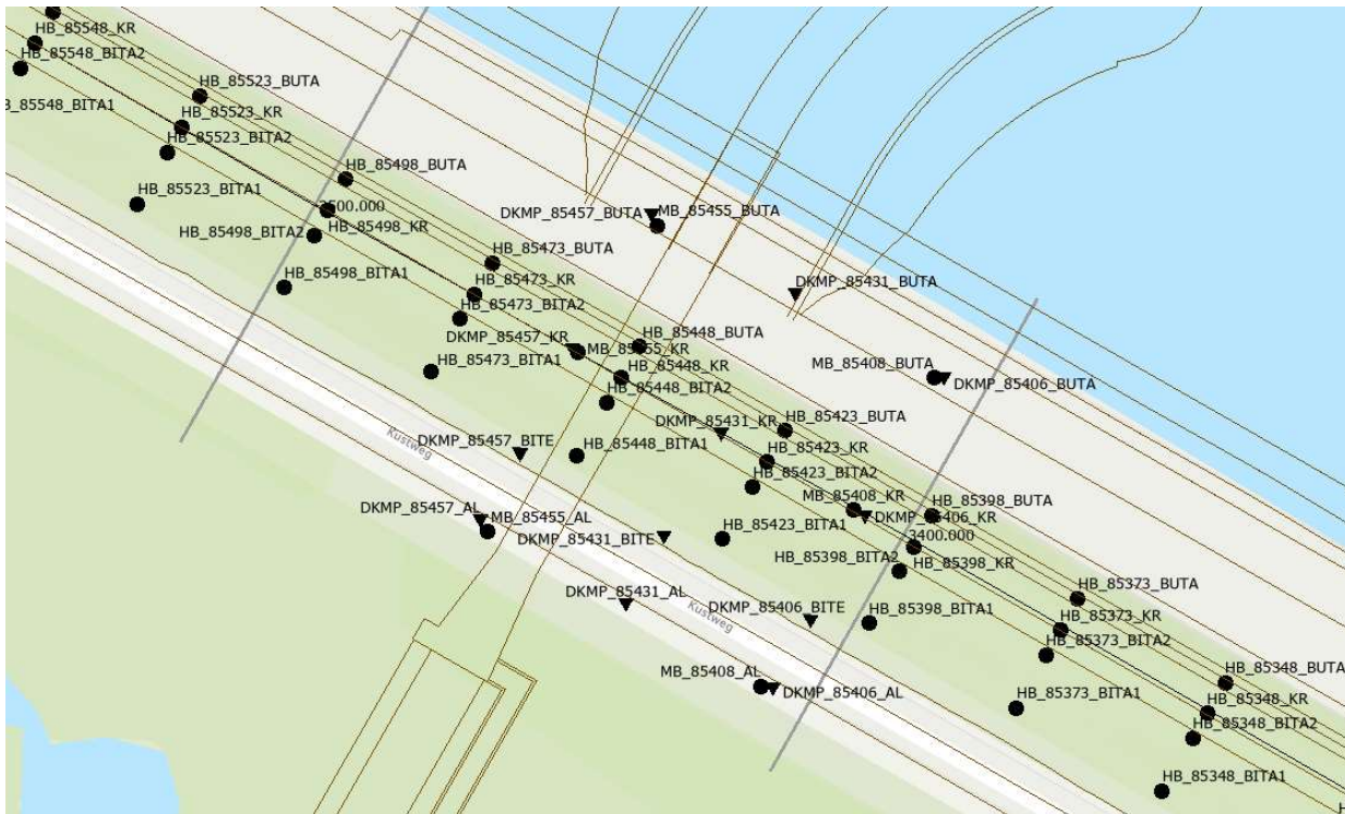
Figuur 2-3: Grondonderzoek ter plaatse van dijkdoorkruising
