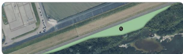
1 Verwijderen bossage ten zuiden van Kustweg en aanbrengen voorbelasting
