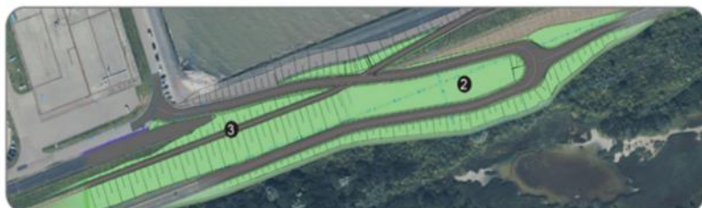
2 Opbouwen bekleding en asfalteren weg 3 Realiseren fietspad met aansluiting rotonde
