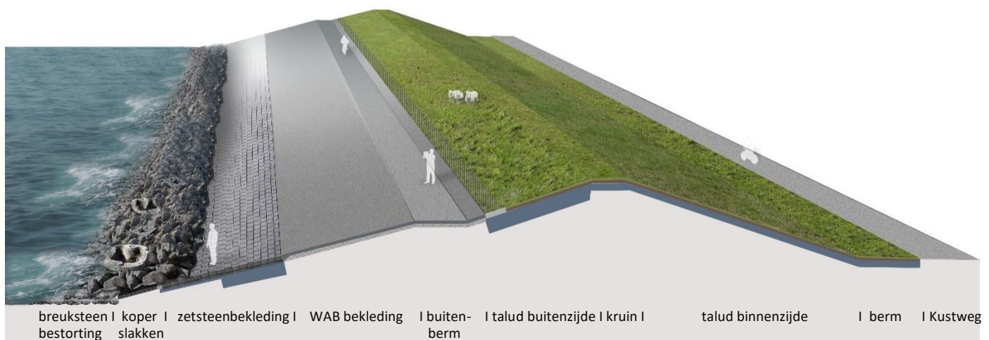
Figuur 3-1 Impressie van de landelijke dijk. Het bovenste deel van het talud aan de buitenzijde van de dijk wordt voorzien van gladde bekleding, de onderzijde wordt ruw (stortsteen). De kruin en binnenzijde worden ingezaaid met een grasmengsel
