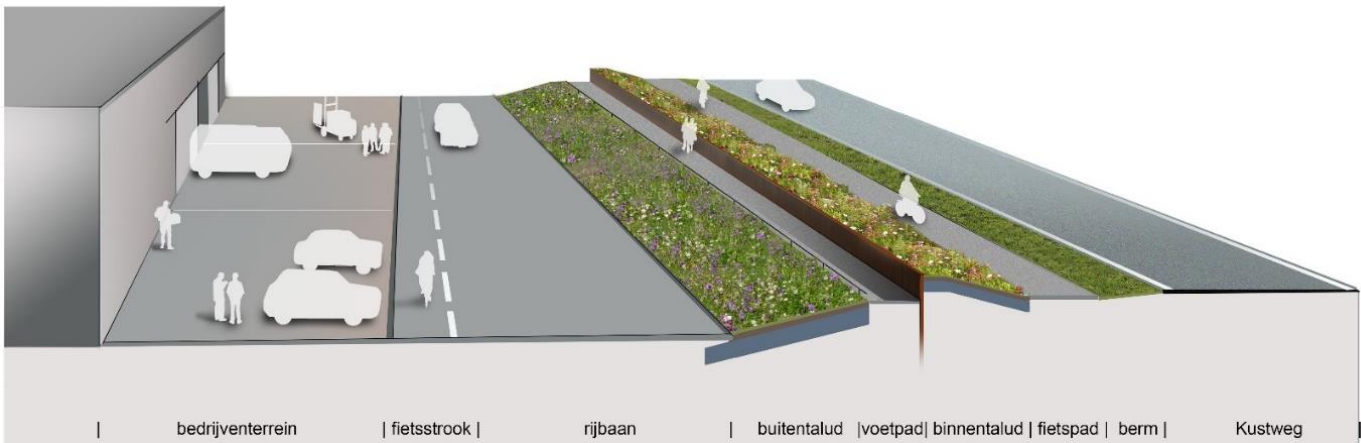
Figuur 3-4 Dwarsdoorsnede van het ontwerp van de dijk in de Haven (sectie 5 boven en sectie 7 beneden)
