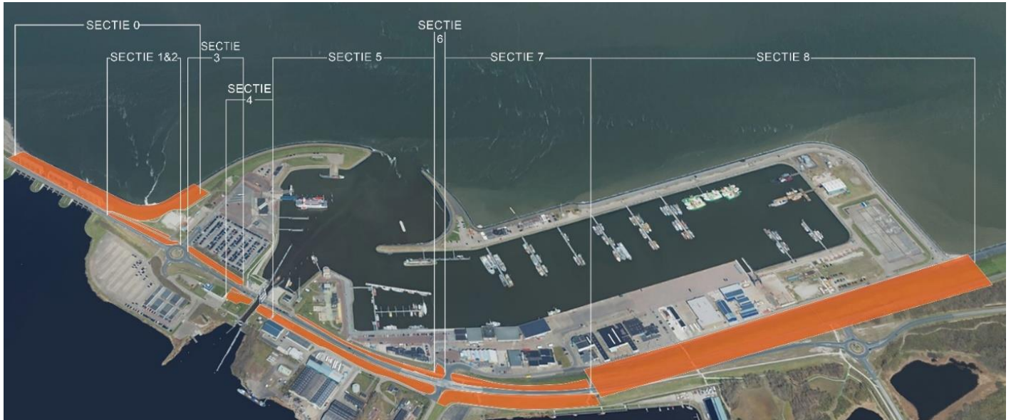
Figuur 3-8 Binnen deeltraject Haven sectie 1, 2, 4, 5, 6, 7 en 8 wordt (onder andere) de bermbekleding vervangen. Dit gebeurt binnen elke sectie op eenzelfde wijze
