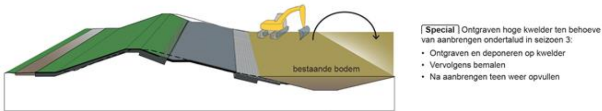
Figuur 3-3 Weergave van het ontgraven van de hoge kwelder in het meest oostelijke deel van de deeltraject Landelijke dijk.
