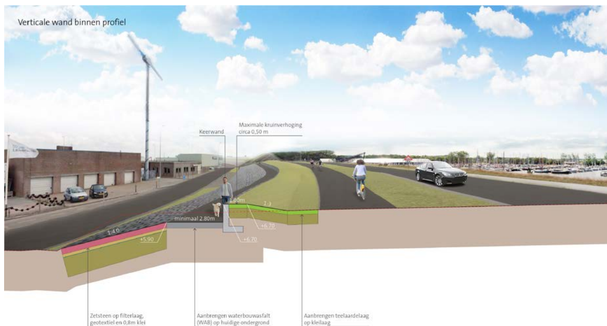
Figuur 25: Dwarsdoorsnede van het beoogd VKA van de dijk in de Haven (maatvoering indicatief)
