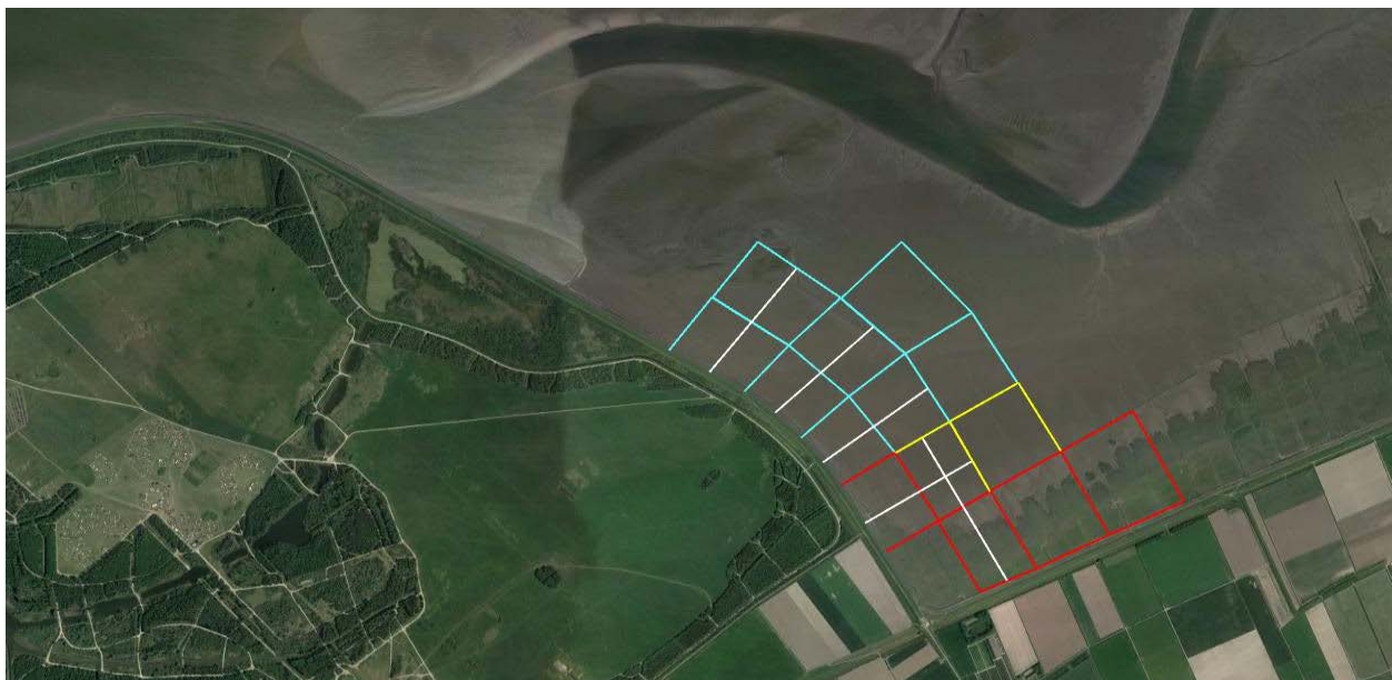
Figuur 31: Locatie kwelderontwikkeling met rijshouten dammen (het schetsontwerp wordt nader uitgewerkt in de planuitwerking en onderzocht op effecten en haalbaarheid)
