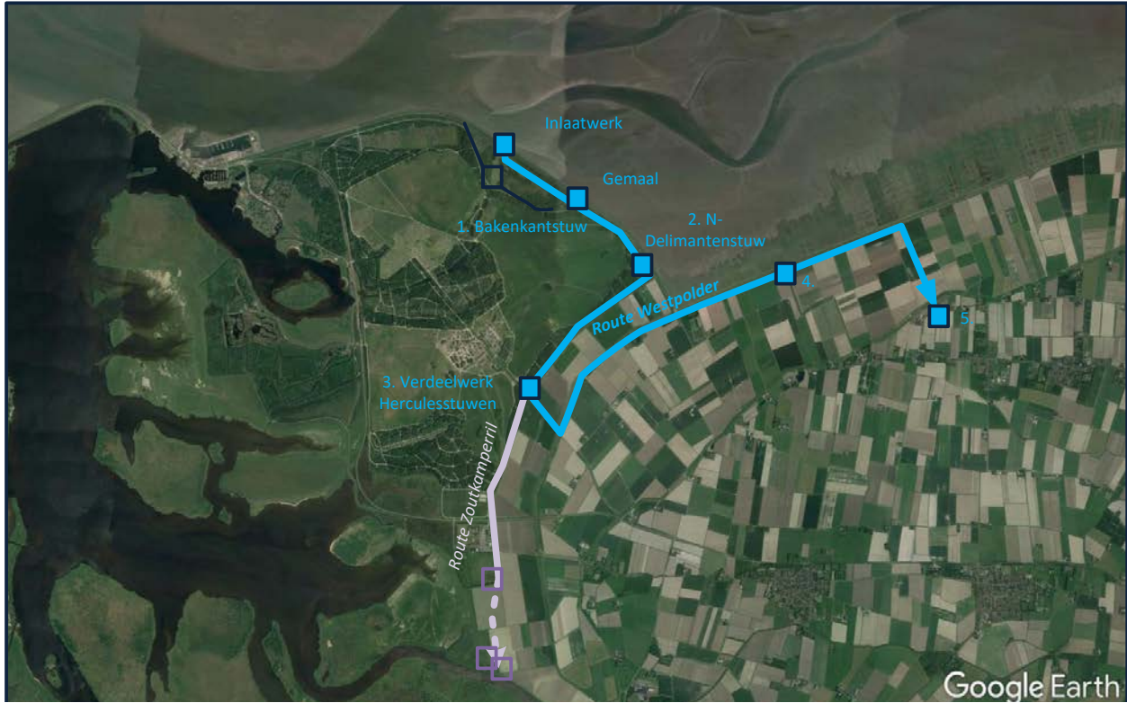
Figuur 34: Overzicht van de aanpassing van 5 bestaande kunstwerken in de vismigratieroute (route Westpolder, blauwe route). De maatregelen voor de route Zoutkamperril zullen nader worden uitgewerkt in de Planuitwerkingsfase.
