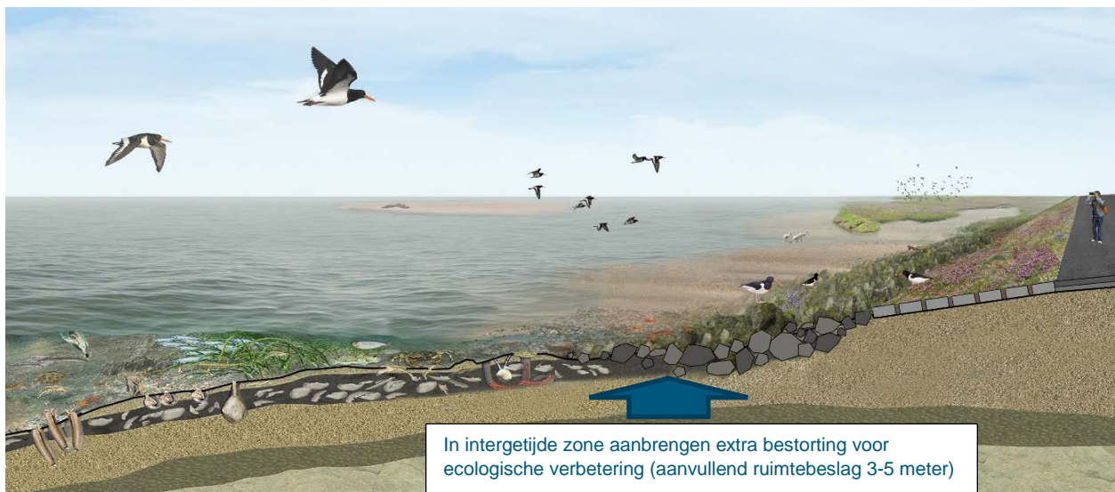
Figuur 29: Maatregelen voor ecologische verbetering van de natuurlijke overgang met de dijk (aanbrengen bestorting in de intergetijdzone)
